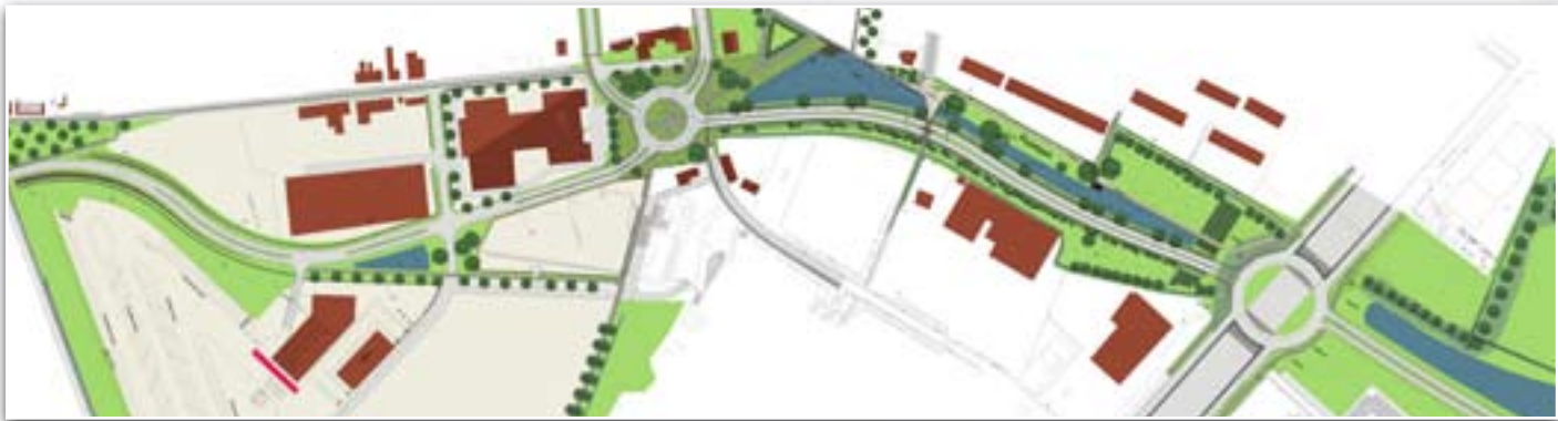
Boom - Rumst. Voorontwerp N171 tussen A12 en bedrijventerrein Krekelenberg - met wetenschapspark UA. De komst van een nieuwe weg en bufferbekkens wordt gebruik voor de aanleg van een buurtpark tussen twee woonwijken. Dat Rupelpark is een deel van een nieuwe groene vinger, die de Rupelvallei via de open ruimte tussen A12 en E19 met het toekomstige stadsbos voor Antwerpen verbindt.
