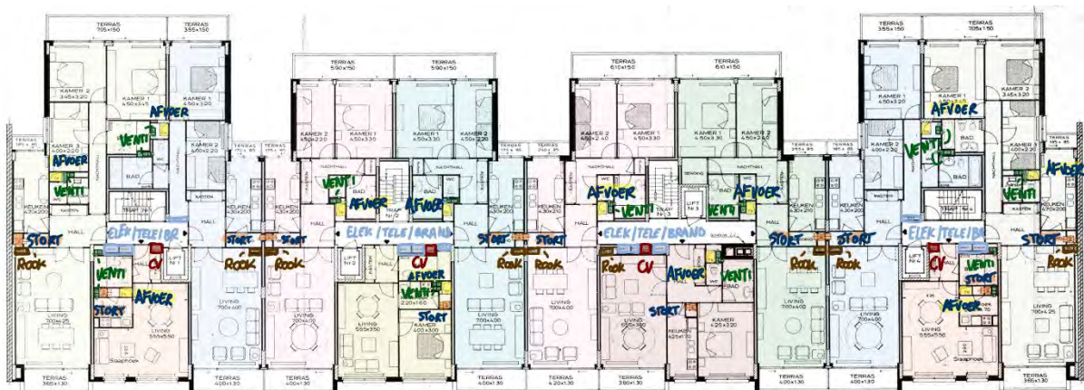
afbeelding 06 Overzicht schachten: rood = CV, blauw = elektriciteit / telecom / brand, geel = afvoeren, groen = ventilatie, oranje = storkokers, bruin = rookafvoer mogelijke kachel
