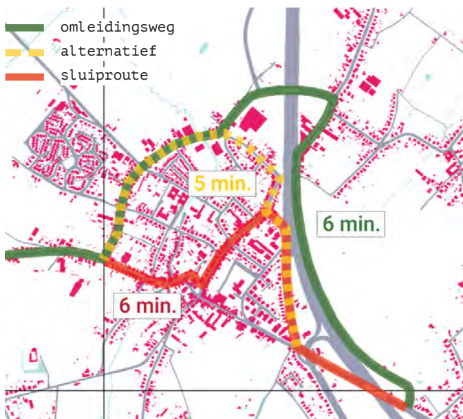
Reistijden omleidingsweg, alternatieve omleiding en sluipteg doorheen Wolvertem Centrum.
