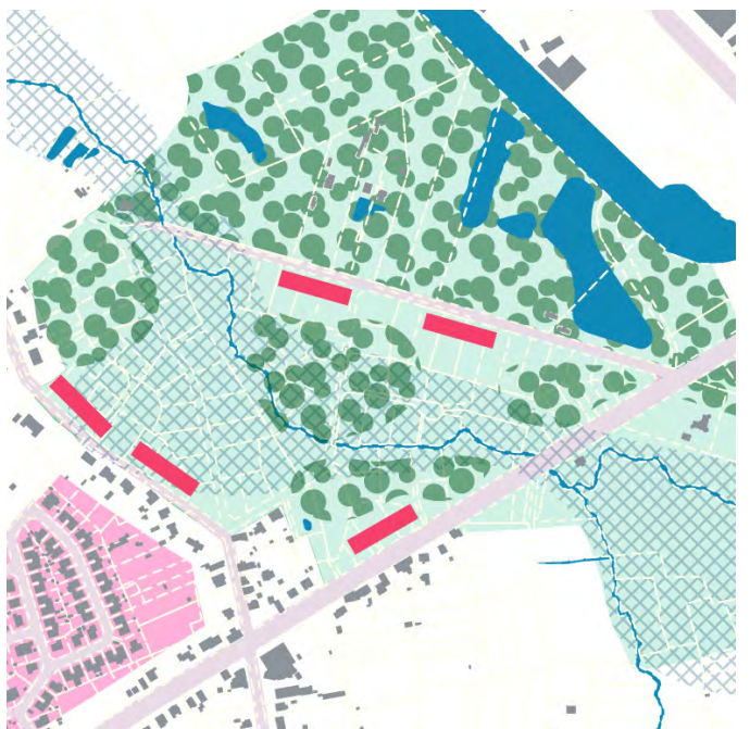
Dit woonpark krijgt een waterbergend karakter. Op de randen kan worden bebouwd (vorm van urban villa's of kwalitatieve gestapelde wooneenheden).
