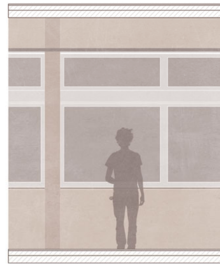
opbouw bestaande gevel: - 190mm metselwerk (niet dragend) - 70mm luchtspouw - 120mm prefab betonpaneel
