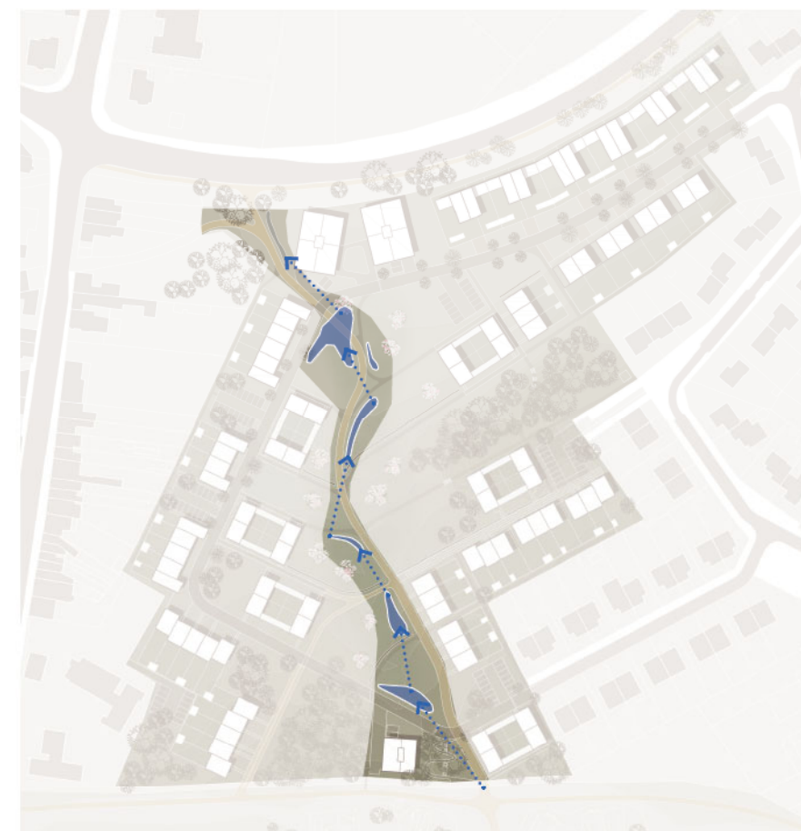
Waterhuishouding via een cascadesysteem van opeenvolgende wadi's.
