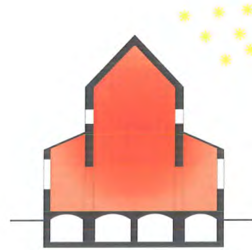
DIKKE MUREN: THERMISCHE MASSA winter: vertraagde afkoeling
