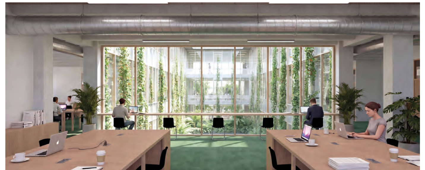
Een kantoor - De kantoren worden 'in hun natuurlijke staat' geplaatst. Geen verlaagde kunststof plafonds, maar de directe betonstructuur, aangevuld met technieken in het zicht en houtvezel voor akoestische absorptie tussen de balken.
