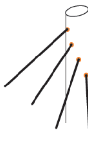
Kabel Joints roteren rondom de Pyloon
