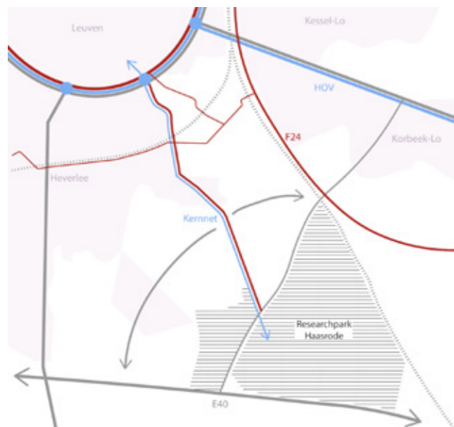
Schema mobiliteit: Geldenaaksebaan voor OV kernnet en fietsnetwerk die aan het klimaatplein aantakt op de ringboulevard
