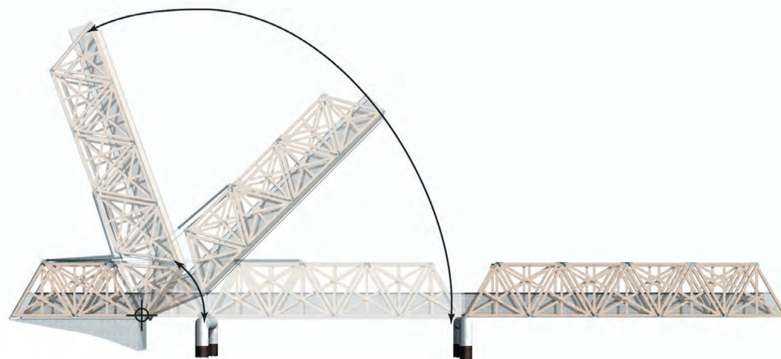
Aanzicht Kanaalbrug VASTE + OPENGAANDE BRUGCONSTRUCTIE
