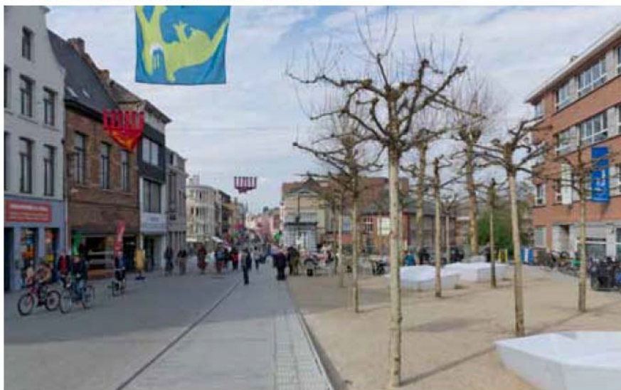
regenwater kan insijpelen in de halfverhardng
