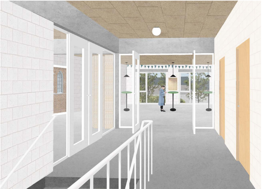
Een lichtrijke circulatiezone centraal in het plan op de eerste en tweede verdieping geeft toegang tot de verschillende polyvalente ruimtes. De draagstructuur bestaande uit betonnen balken en kolommen kan met invulwanden (robuustere uit metselwerk of lichtere houtskeletbouw) worden ingevuld om het programma te huisvesten. De lichtere wanden kunnen aangepast worden in de toekomst zonder impact op de structuur.
