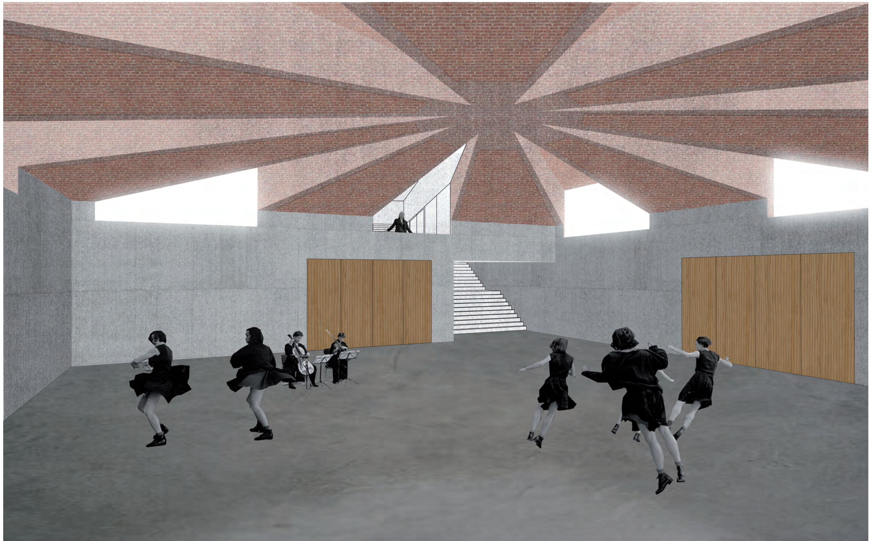
Zicht op de polyvalente zaal en het betongewelf met verloren baksteenbekisting
