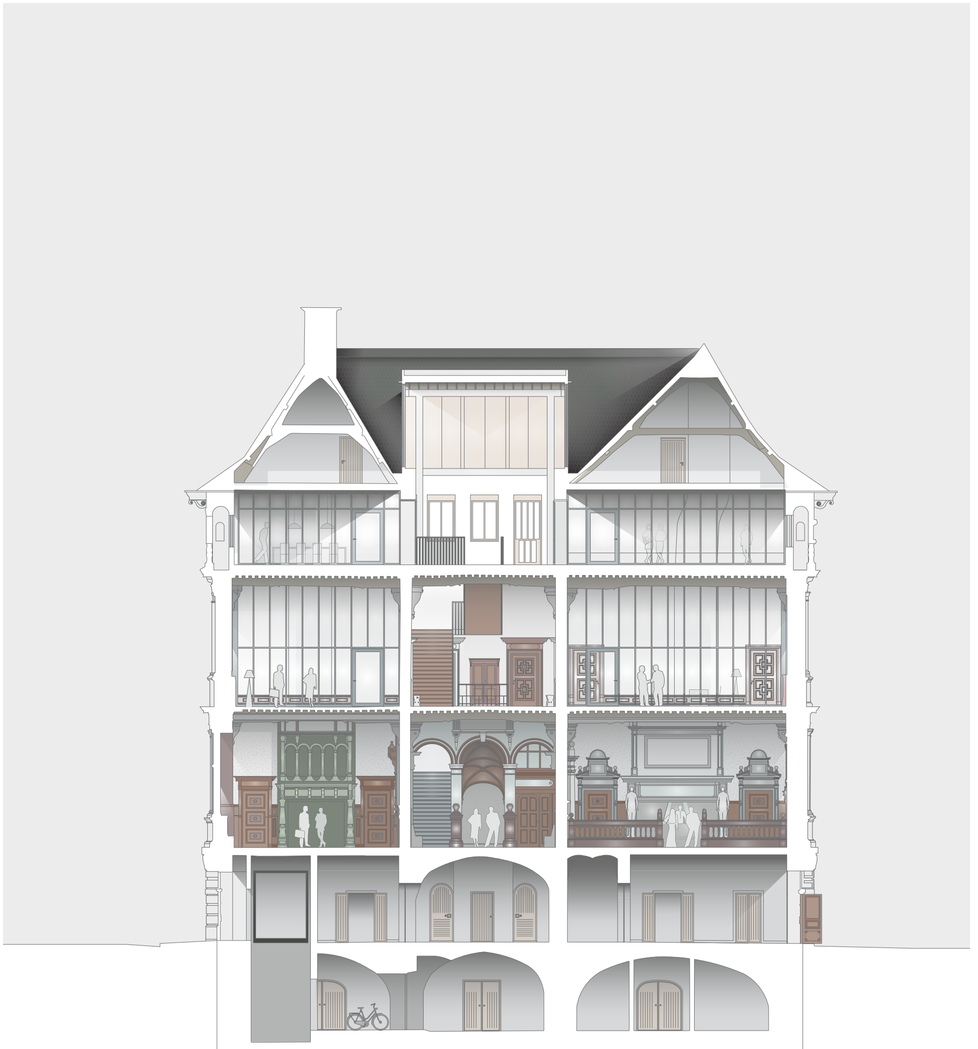
Afb. 17: Dwarssnede door de noordelijke centrale ruimte.
