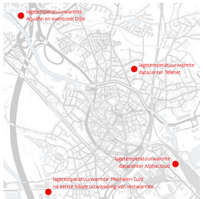
Beschikbare grote warmtebronnen rondom het stadscentrum
