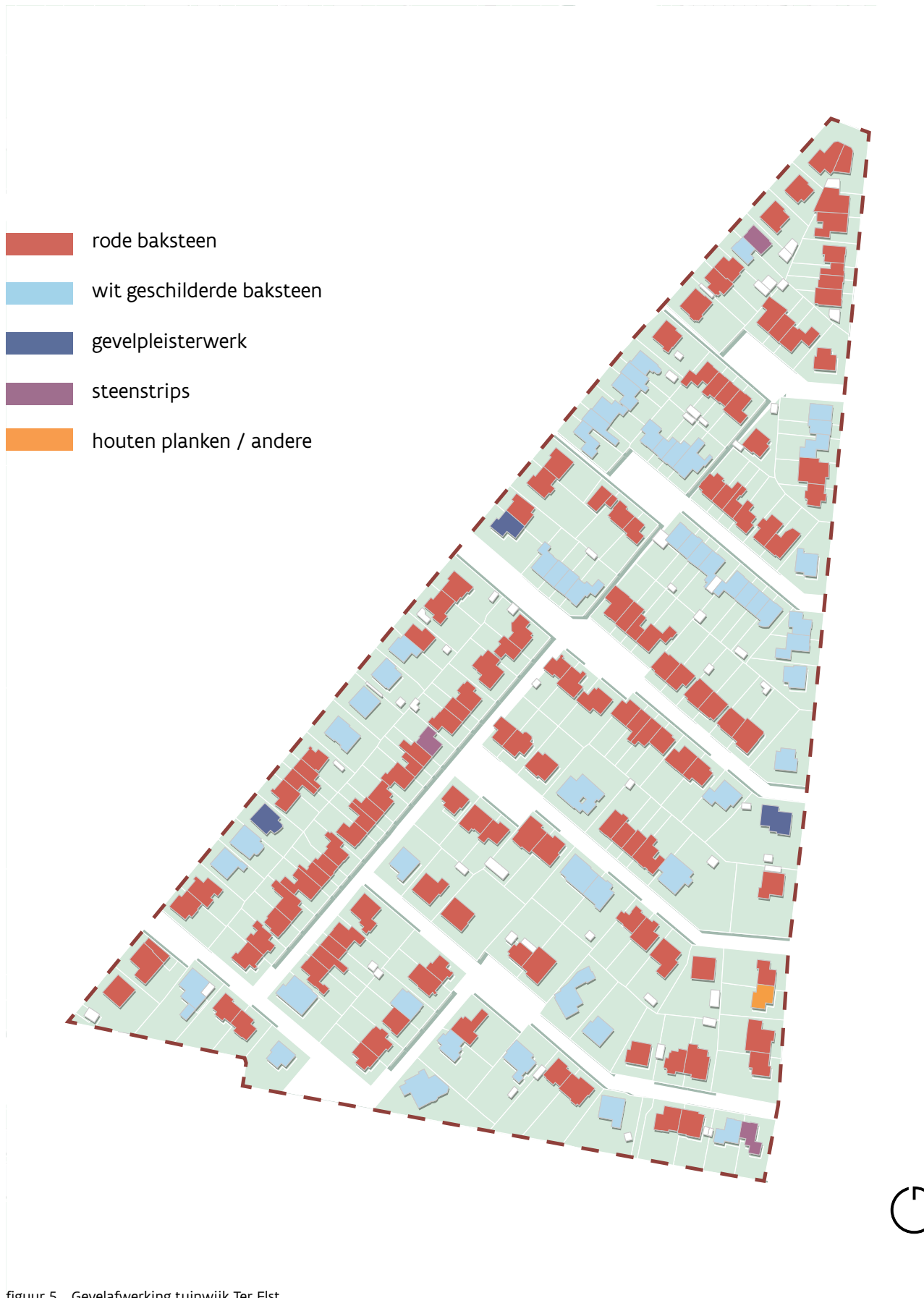
figuur 5 Gevelafwerking tuinwijk Ter Elst
