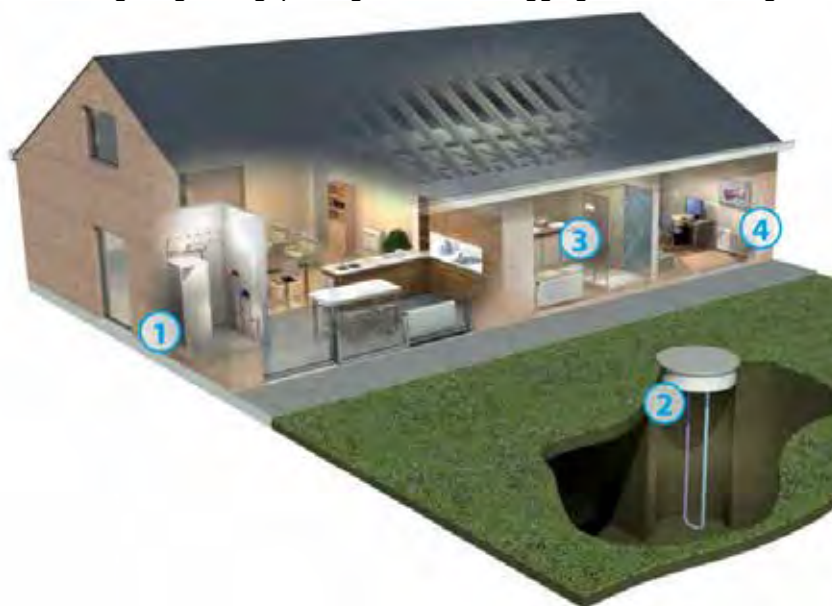
Figuur 26: Voorbeeld van een huishouden met een geothermische grondcollector
