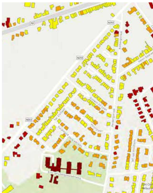
figuur 32 De warmtevraag van de woningen bij isolatie niveau 1 (dak en ramen) en isolatie niveau 2 (dak, ramen en schrijnwerk)
