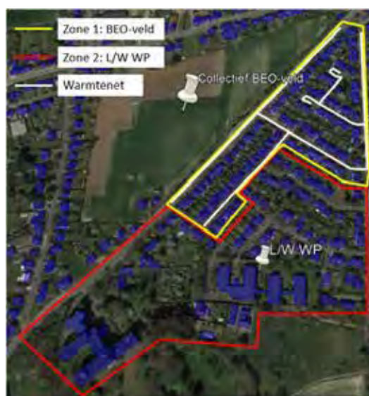
Figuur 25: combinatie van individuele en collectieve bebouwing afhankelijk van het type bebouwing
